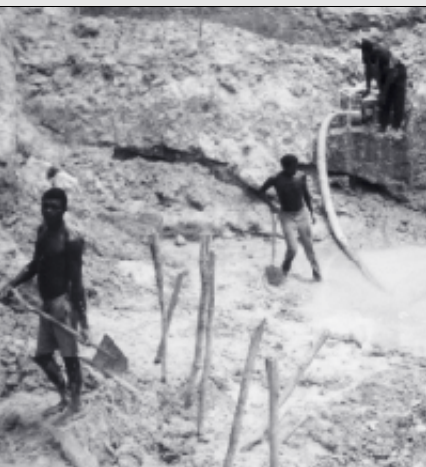
Une petite pompe draine un dépôt de diamants alluviaux. Photo: Des Garvey
